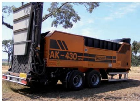
**Fotografía nº 3.** Astilladora móvil Doppstadt AK430 con motor autónomo.
